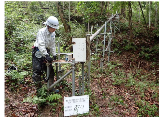
図5-2:観測機器(地盤伸縮計)
