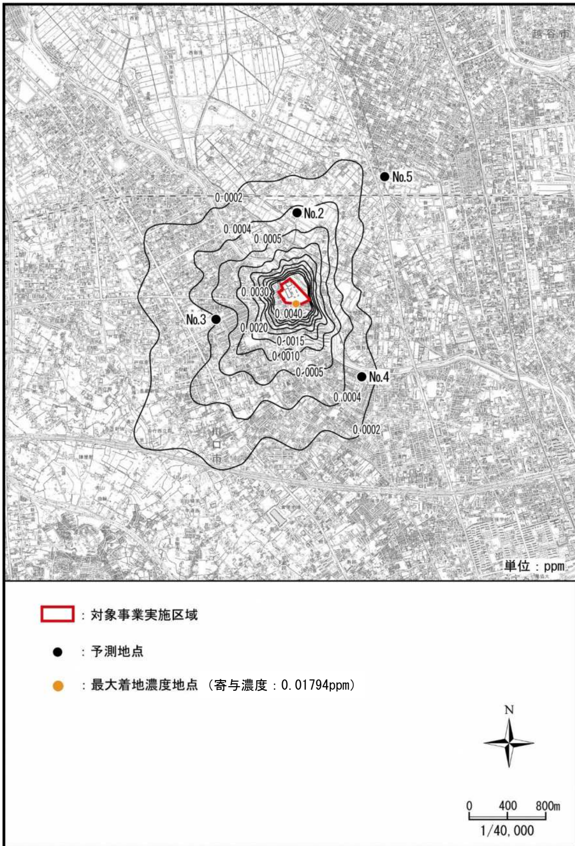
図 9.1-10 建設機械の稼働に伴う窒素酸化物の等濃度分布図 (年平均値)
