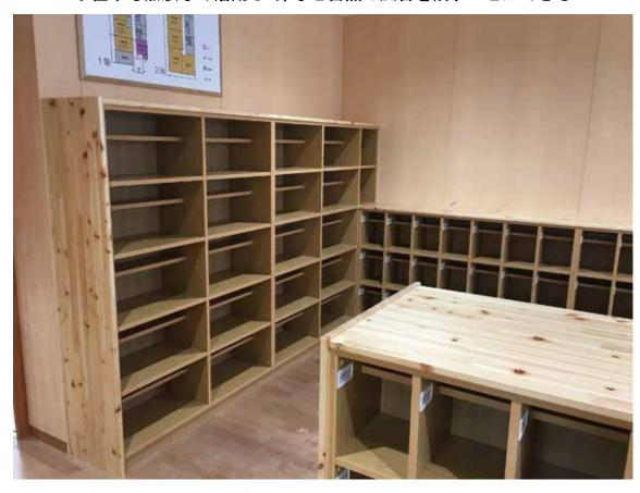
家具本体はエコクリアボード(パーティクルボード)、天板・側板にヒノキ集成材を使用。 耐久性を確保しながら、柔らかいヒノキ材の温かみを生かすことができる。 安全性を考慮し本体の小口材には厚手(3 mm)の ABS 樹脂を採用した。 製造場所: 弊社熊谷工場
