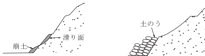
図 5-42 土のう工による応急措置
