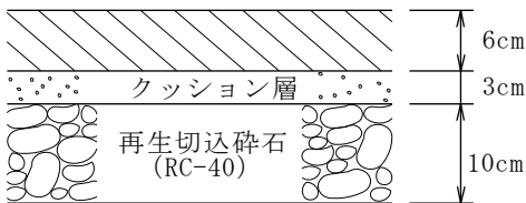
路床 図6-21 コンクリート平板舗装
