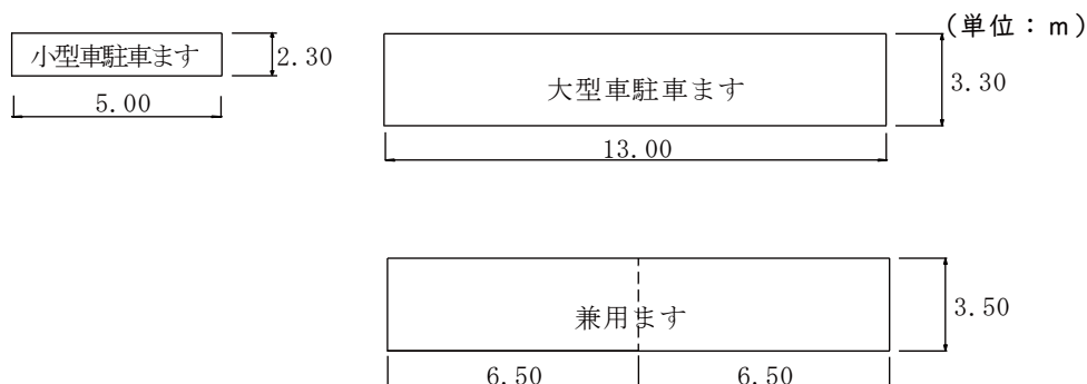
図2-16 大型車、小型車の駐車ます寸法
