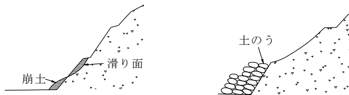
図 5-42 土のう工による応急措置
