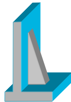
控え壁式擁壁
