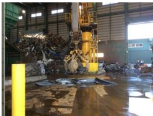
図 13 ローダーでシュレッダーに投入
