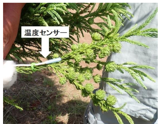
図2 供試枝と温度センサーの外観
