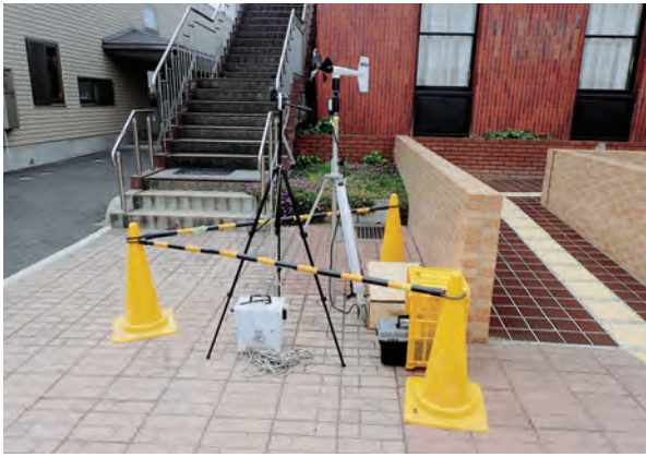
写真13-3 環境大気中の石綿濃度の測定
