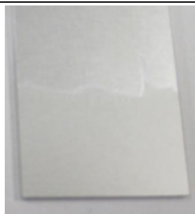
図1 アルマイト処理したアルミ板 (処理時間 20分)
