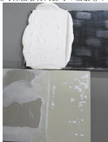
図3 接合試験片の引張せん断試験後の状況 (アルマイト処理時間60分)
