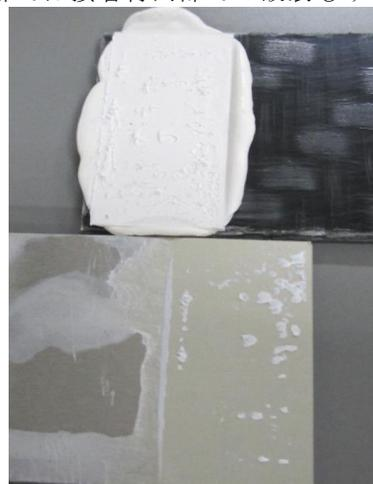
図3 接合試験片の引張せん断試験後の状況
