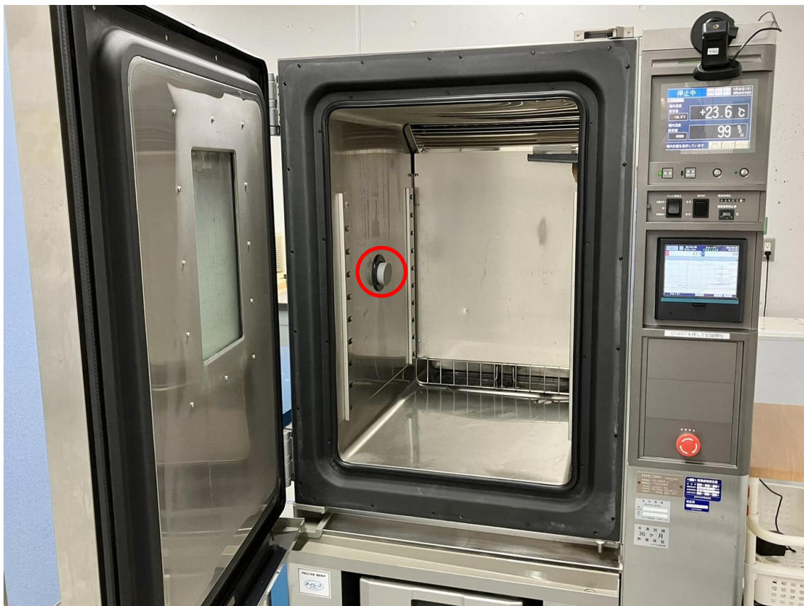
恒温恒湿槽2・ケーブル孔位置(左側面)
