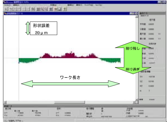
図3 超硬ポールエンドミルによるレンズ加工の形状誤差
