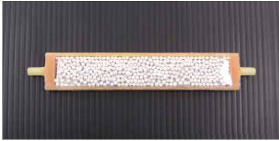
図6 活性炭と酸化チタンを担持したゼオライトを仕切ったフィルター
