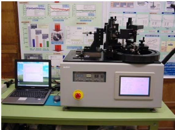
図2 摩擦摩耗試験システム
