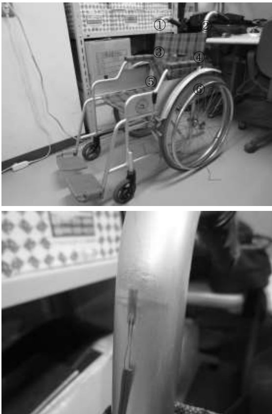
図2 歪みゲージ貼付車椅子
