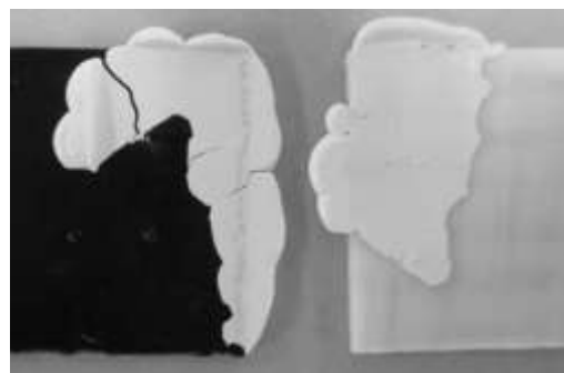
図5 樹脂③を使用した接着剤によるGF-PAとGF-PP接合試験片の引張せん断試験後の破断面写真(6s印加)
