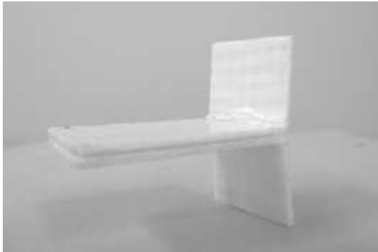
図6 L字型をしたGF-PPを誘電加熱接合した試験片
