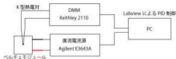
図 7 ペルチェモジュールの温度制御概略図
