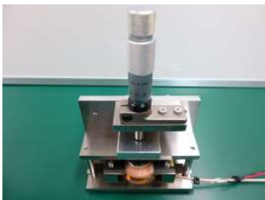
図1 試作した超微小硬さ測定機
