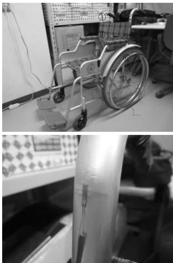
図2 歪みゲージ貼付車椅子
