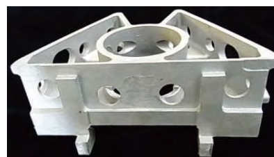
図3 ハイブリッド砂型低圧鋳造法により製造した40%SiC配合のアルミ基複合材鋳物(製品重量1.8kg)
