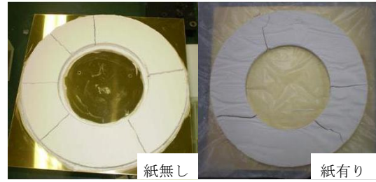
図4 乾燥時摩擦の低減
