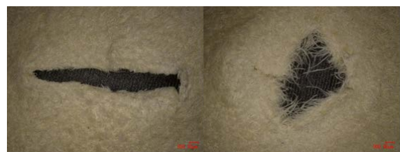
図10 鋭利な穿刺針の貫通穴 (左) と鈍らせた穿刺針の貫通穴 (右) の写真
