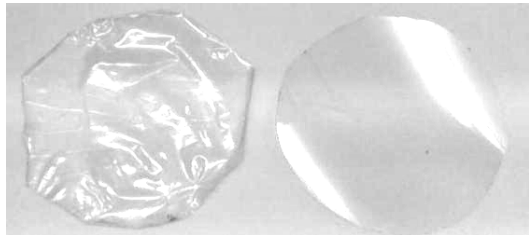
図8 接着剤の遊離塗膜(左)と積層試験片(右)
