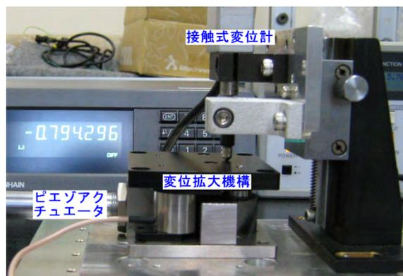
図2 接触式変位センサによる変位測定
