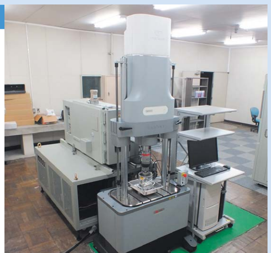
メーカー：インストロン ジャパン Co. Ltd. 型式：ElectroPuls E10000、Linear-Torsion
