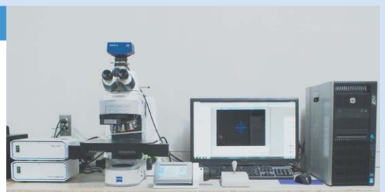
メーカー：カールツァイス マイクロスコピー株式会社 型式：Axio Imager. Z2m
