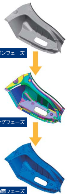
CAD データと測定データの誤差表示
