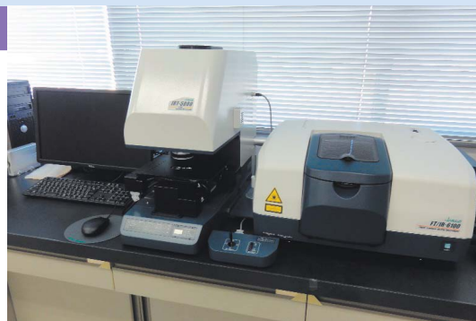
メーカー：日本分光株式会社 型式：本体 FT/IR-6100 顕微鏡 IRT-5000
