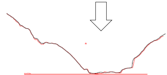
土石流発生前後の断面比較図
