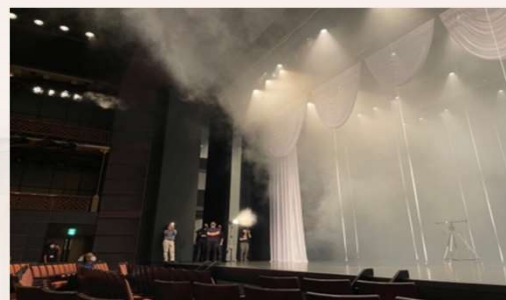
③スモークに実験により気流を可視化 →客席と舞台における広範囲の空気の流れを把握
