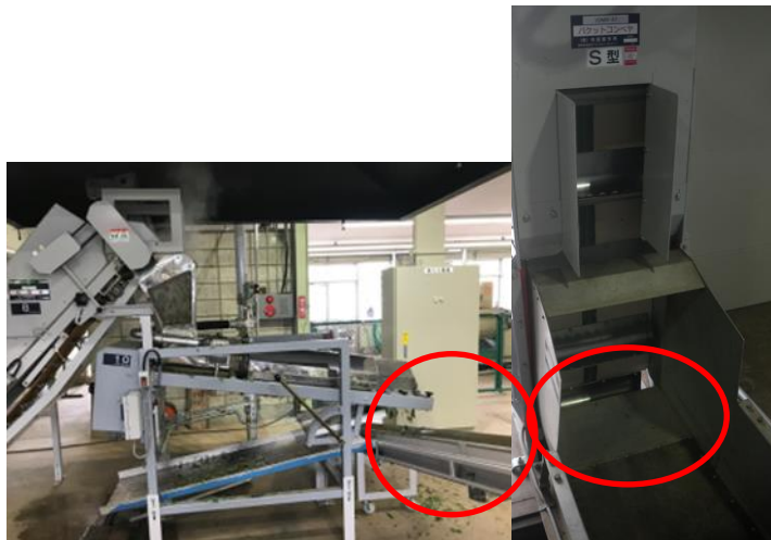
図1 蒸機から蒸した葉が流れるベルトコンベアーおよび垂直バケット
